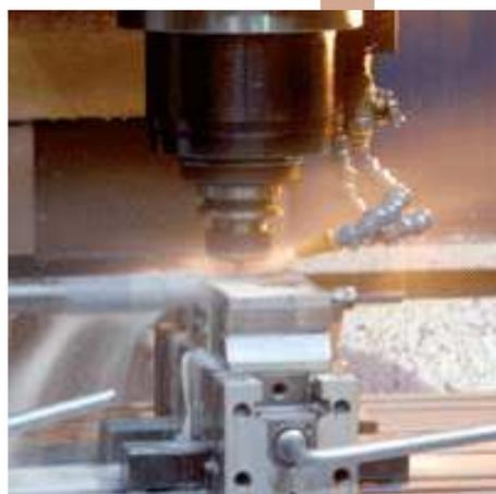
Per la lavorazione di **acciai duri, al cromo molibdeno, temprati ecc.** su centri controllo numerico, torni, frese, brocciatrici, maschiatric ecc. Garantisce **ottima lubrificazione e protezione** dalla ruggine anche in condizioni gravose.
